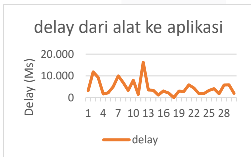
Gambar 10. Geafik Pengujian delay dari alat ke aplikasi Android.
