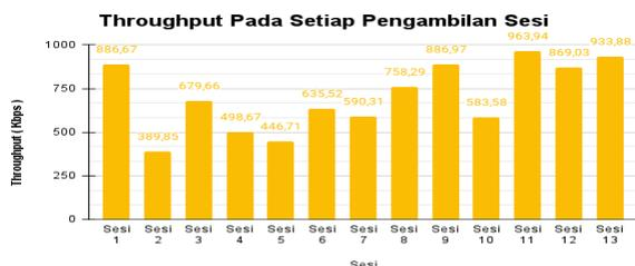
GAMBAR 4.2 Hasil Pengujian Throughput
