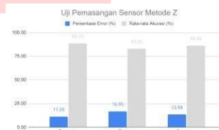
Gambar 11 Uji kalibrasi sensor pemasangan metode-z.
