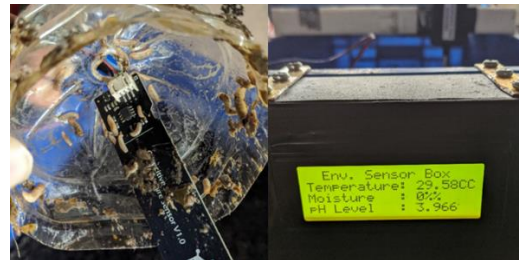
Gambar 7. Error Pembacaan Sensor Kelembaban
