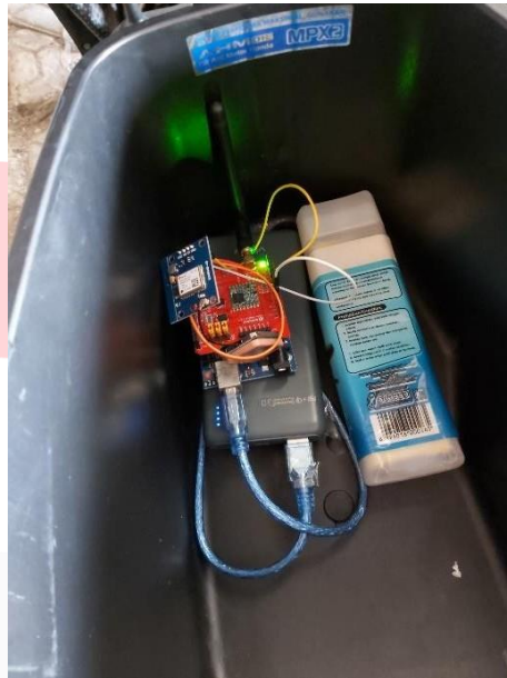
Gambar 3. 3. 1 Foto Node yang ditempatkan di bagasi motor
