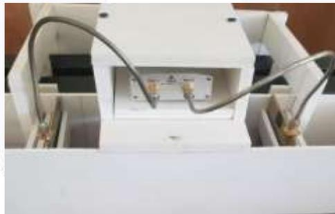
Gambar 3. 3 Model GPR dengan Pocket VNA
