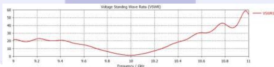
Gambar 3.4 VSWR antenna rectangular array 2x2 dengan u slot setelah optimasi
