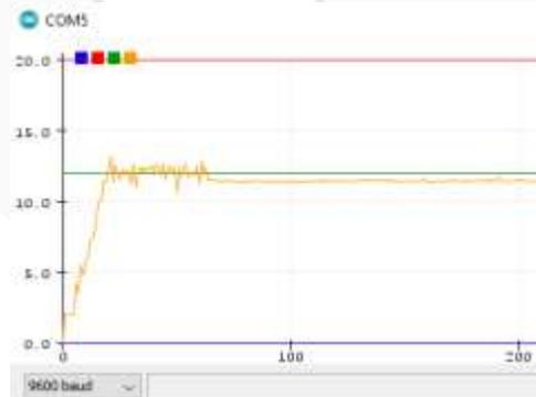
Gambar 4.7 Grafik Kontrol PID Pada Aki 12V
