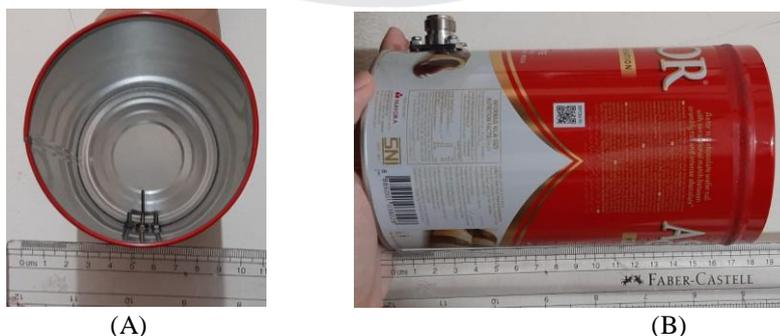
Gambar 12 Realisasi *cantenna* Kecil (A) Tampak Depan (B) Tampak Samping
