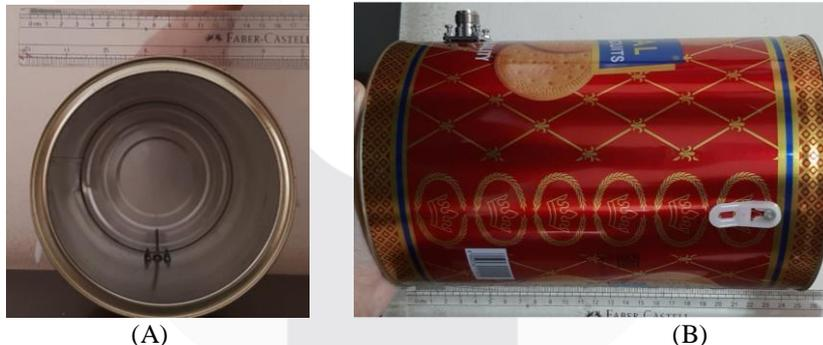
Gambar 11 Realisasi *cantenna* Besar (A) Tampak Depan (B) Tampak Samping
