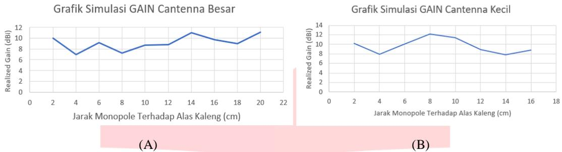
Gambar 10 Hasil simulasi gain (A) *cantenna* besar (B) *cantenna* kecil
