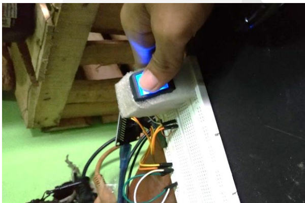
Gambar 21 Proses Percobaan Mendeteksi Pada Sensor Sidik Jari
