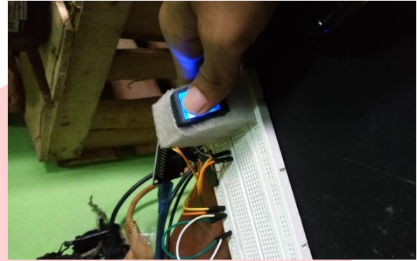
Gambar 18 Proses Enroll Pada Sensor Sidik Jari
