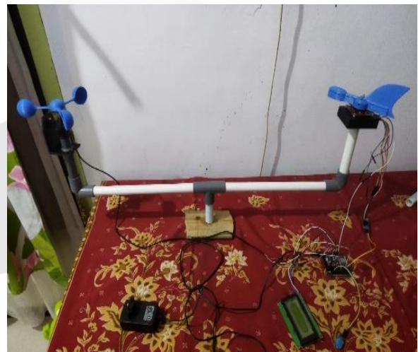
Gambar 4. 12 Pembuatan prototipe mendeteksi kecepatan angin, arah angin, kelembapan dan suhu
