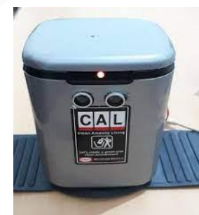
Gambar 2- 2 Sistem saat ini tempat sampah yang menggunakan sensor ultrasonik
