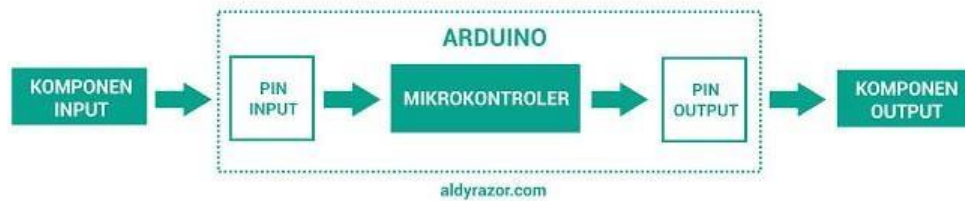
Gambar 2. 8. prinsip kerja pada arduino [26]
