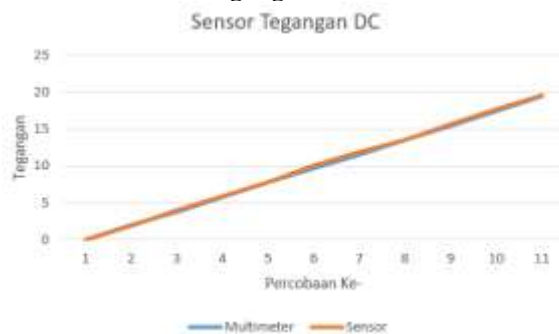
Gambar 4-6. Kalibrasi Sensor Tegangan DC
