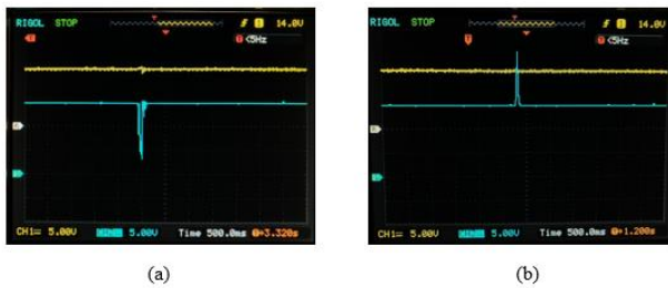
Gambar 4. 16 Hasil Pengukuran Beban di 65 \Omega Menjadi (a) 55 \Omega (b) 75 \Omega (Note : x = 500 \text{ ms/div} dan y = 5\text{V/div} , Sinyal Kuning = Input , Sinyal Biru = Ouput)
