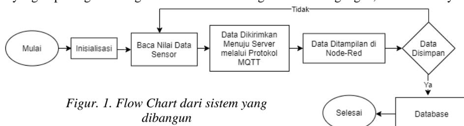
Figur. 1. Flow Chart dari sistem yang dibangun
