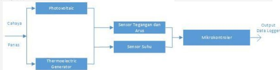
Gambar 2 Diagram Blok Sistem
