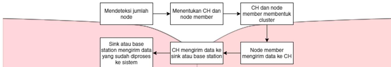
Gambar 3. Blok Diagram
