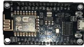
Gambar 1. NodeMCU ESP8266
