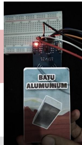
Gambar 4.3 Tap kartu ke RFID
