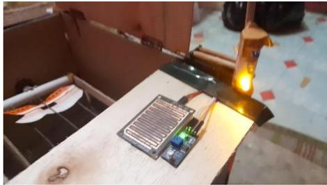
Gambar 4.2.4 Kondisi notifikasi Led ketika terang dan proses pembalikan berlangsung.
