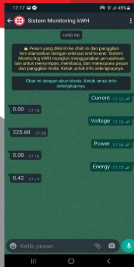
Gambar 4.2 Notifikasi data tegangan, arus, daya, dan energi listrik ke Whatsapp .
