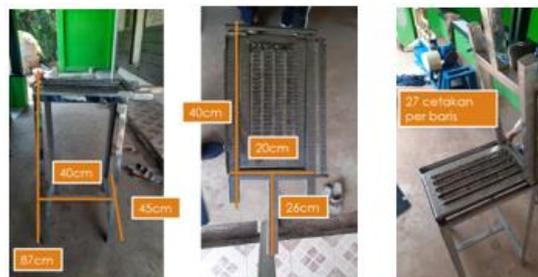
Gambar III. 1 Ukuran alat eksisting
