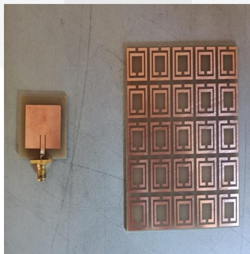
Gambar 4.1 Realisasi mikrostrip antenna dan metamaterial sebagai reflektor.
