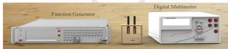
Gambar 3. Proses pengujian karakterisasi koil tanpa objek
