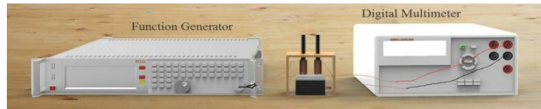
Gambar 5. Proses pengujian karakterisasi koil dengan objek
