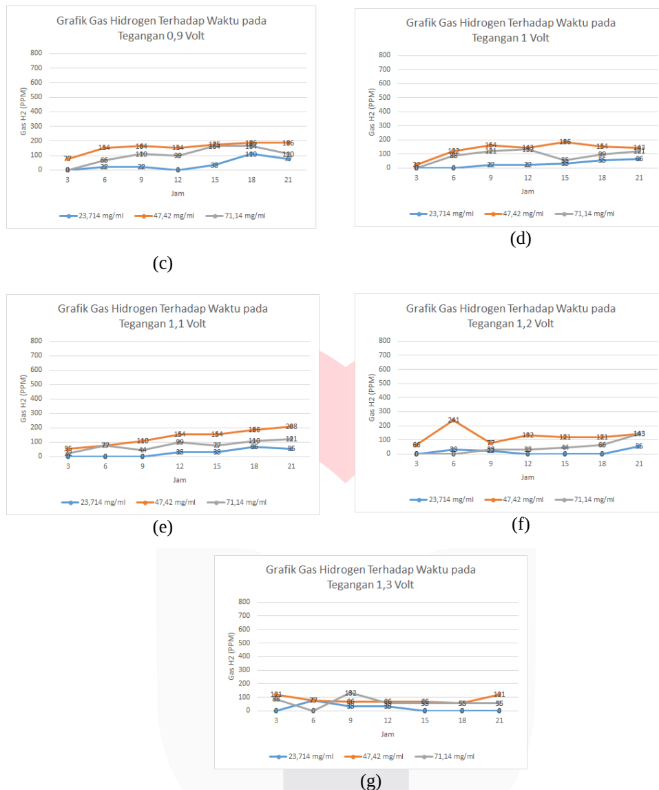
Gambar 4.2 Grafik Hasil Pengamatan Gas Hidrogen Terhadap Variasi Tegangan
