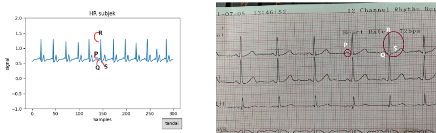
Gambar 5 Sinyal yang terekam oleh prototype dan EKG Bionet Cardiocare
