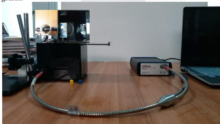
Gambar 2.2 Skema set-up alat pengujian PL
