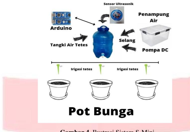
Gambar 4. Ilustrasi Sistem S-Mini
