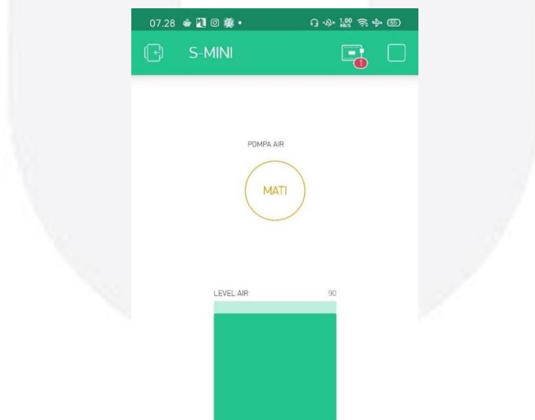
**Gambar 9.** Tampilan pada blynk saat pompa OFF manual
