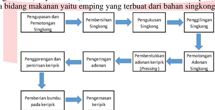
Gambar I. Alur Pembuatan Emping Singkong
