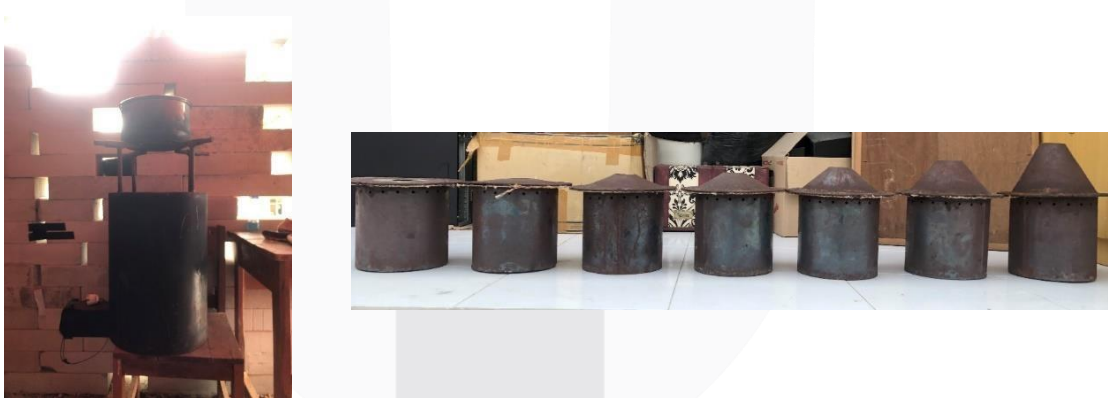
Gambar 3. (a) Badan kompor gasifikasi; (b) varian gasifier
