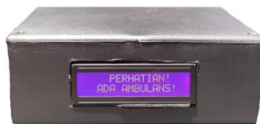
Gambar 7. Tampilan LCD Ketika Jarak Ambulans <40 Meter.
