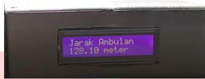
Gambar 6. Tampilan LCD Ketika Jarak Ambulans 150 – 40 Meter.
