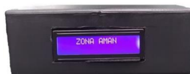
Gambar 5. Tampilan LCD Ketika Jarak Ambulans >150 Meter
