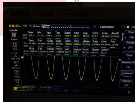
Gambar 4.4 Gelombang Keluaran Inverter
