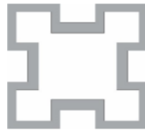
Gambar 2. 3 Bentuk Filter Meander Loop Resonator [4]
