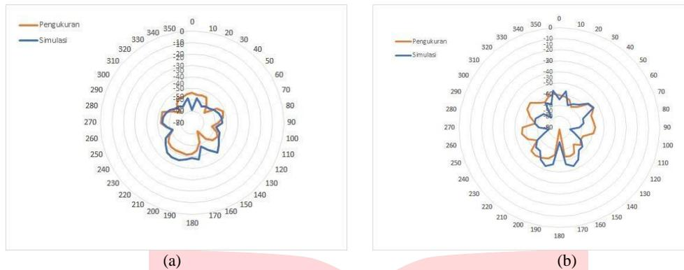
**Gambar 10** (a) Pola radiasi Azimuth pada frekuensi 2,45 GHz dan 2,6 GHz., (b) Pola radiasi Azimuth pada frekuensi 3,35 GHz dan 3,8 GHz.
