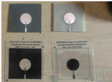
**Gambar 3. 4** Realisasi Antena Patch Sirkular Tanpa Slot.
