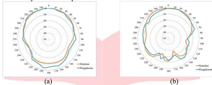
Gambar 4.2 Hasil pola radiasi (a) Azimuth (b) Elevasi
