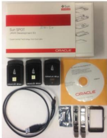
Gambar 1 SunSPOT hardware kit yang ditunjukkan pada Gambar meliputi dua sensor SunSPOT, dan stasiun pangkalan untuk berkomunikasi secara nirkabel dengan sensor.
