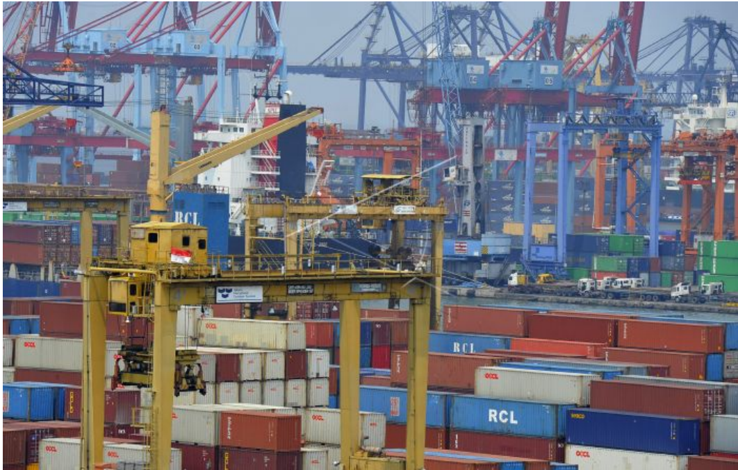
Gambar 1.1. Karakteristik lingkungan pelabuhan yang terdiri atas banyak besi sehingga menyebabkan multipath effect .
