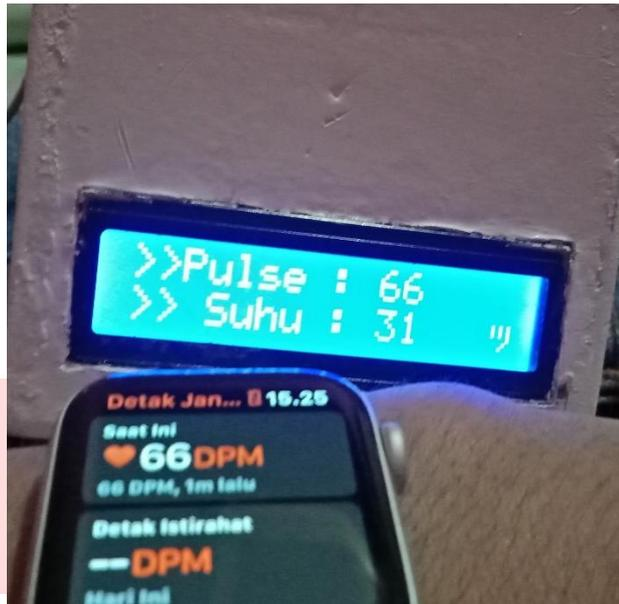
Gambar 3. 1 Percobaan 1 – EKG AD8232 dan iwatch
