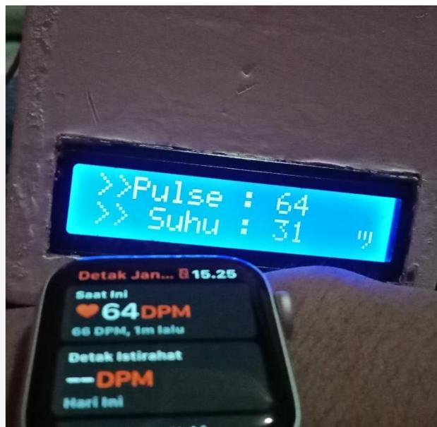
Gambar 3. 2 Percobaan 2 – EKG AD8232 dan iwatch
