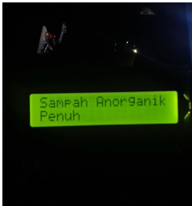
Gambar: Data Sampah Anorganik yang di terima nodeMCU di tampilkan di LCD
