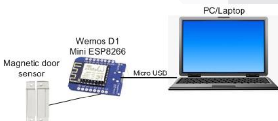
Gambar 3.5a Koneksi pemrograman pada microcontroller WeMOS untuksensor magnetik pintu
