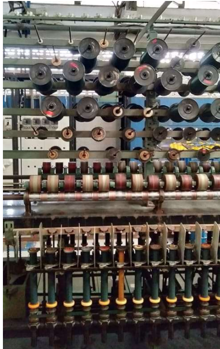
Gambar I. 2 Mesin yang Digunakan pada Proses Twisting
