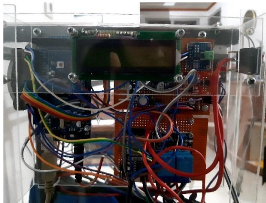
Gambar 4. 1 Implementasi Skematik Rangkaian Jemuran Otomatis
