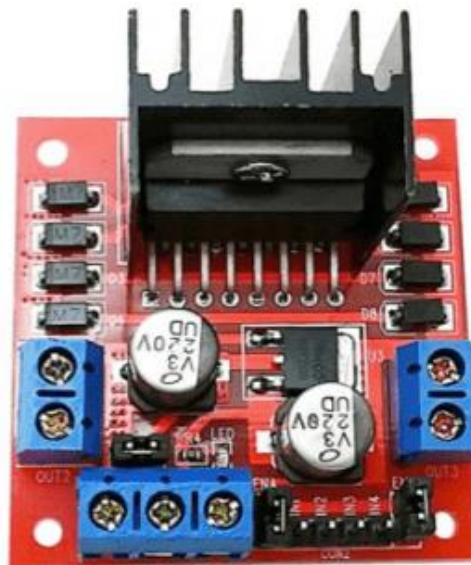
Gambar 2.8 Bentuk fisik IC L298N & Modul Driver
