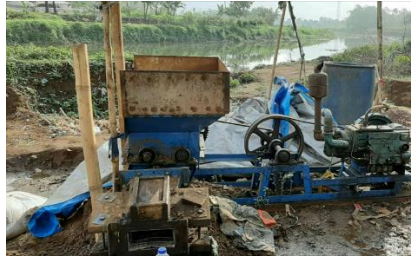
Gambar 2 Mesin Cetakan Batu Bata
