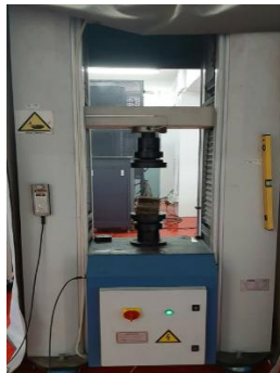
Gambar 3 Mesin Uji Tekan Batu Bata
