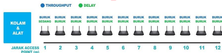
Gambar 7. Analisis QoS berdasarkan jarak access point
