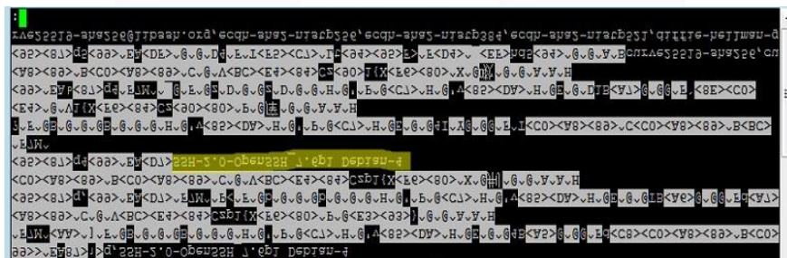
Gambar 4. 3 Paket yang Terenkripsi Menggunakan SSH
