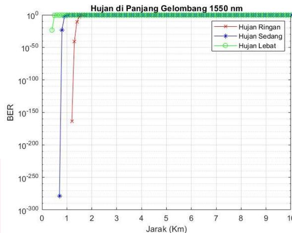
Gambar 4.2 Grafik BER terhadap jarak dengan panjang gelombang 1550 nm
