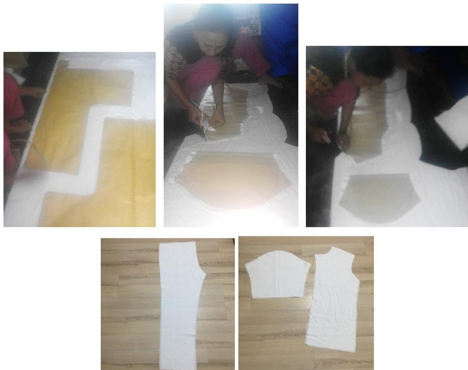
**Gambar 3.29** Proses Pembuatan Pola dan Pemotongan Kain
